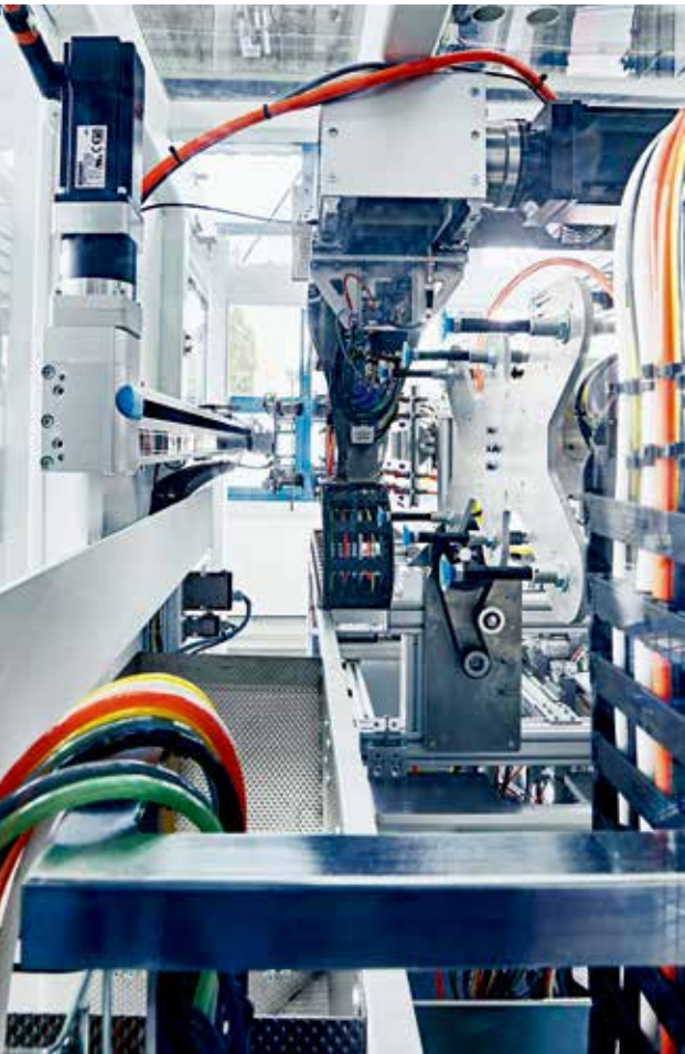
设备使用的四台 AM8000 伺服电机中的两台用于移动主机机械手（右侧电机）和搬运机械手（左侧电机）
