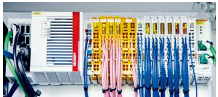
CX5130 嵌入式控制器后面插接有由 EtherCAT 和 TwinSAFE 端子模块构成的 I/O 系统，结构极其紧凑
